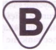
Rys. 1. Taki znak potwierdza, że opatrzone nim urządzenie elektryczne nie grozi porażeniem Źródło: Rączkowski B.: Bhp w praktyce. ODDK, Gdańsk 2002
